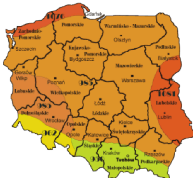
Rysunek 2 Rejonizacja średniorocznych sum promieniowania słonecznego całkowitego padającego na jednostkę powierzchni poziomej w kWh/m 2 /rok. Liczby wskazują całkowite z-sumy energii promieniowania słonecznego w ciągu roku dla wskazanych rejonów kraju
